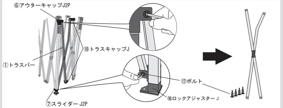
2. ⑬ボルト& ナットセットと⑭ボルトキャップを外します。購入時に付属しております、「六角レンチ」を使用して、⑬ボルト&ナットセットを外し、①トラスバーを 1 本ずつにばらします。
