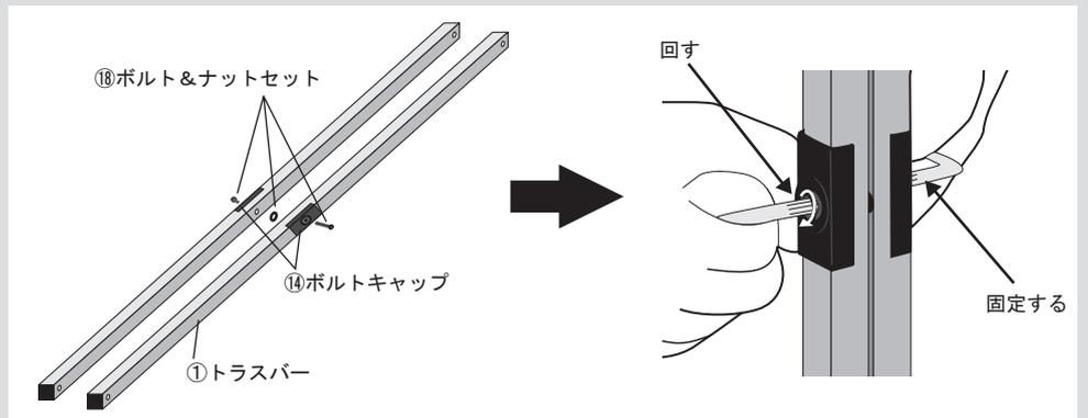
4. 新しい①トラスバーを本体フレームに取付ます。3 でセットしたトラスバーを付属の「六角レンチ」を使用して、⑩トラスキャップ」と⑦スライダー J2P (⑨J3P) と⑥アウターキャップJ2P (⑧J3P)の⑪ボルト 4箇所を取付て完成です。
